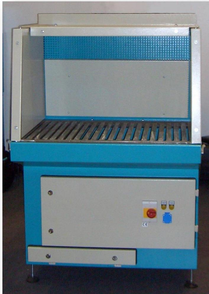
Absaugung über T-Stahlrost und Rückwand, aufklappbare Schutzwände mit Schalldämmung, HEPA- Nachfilter H13, mit Filterüberwachung.
